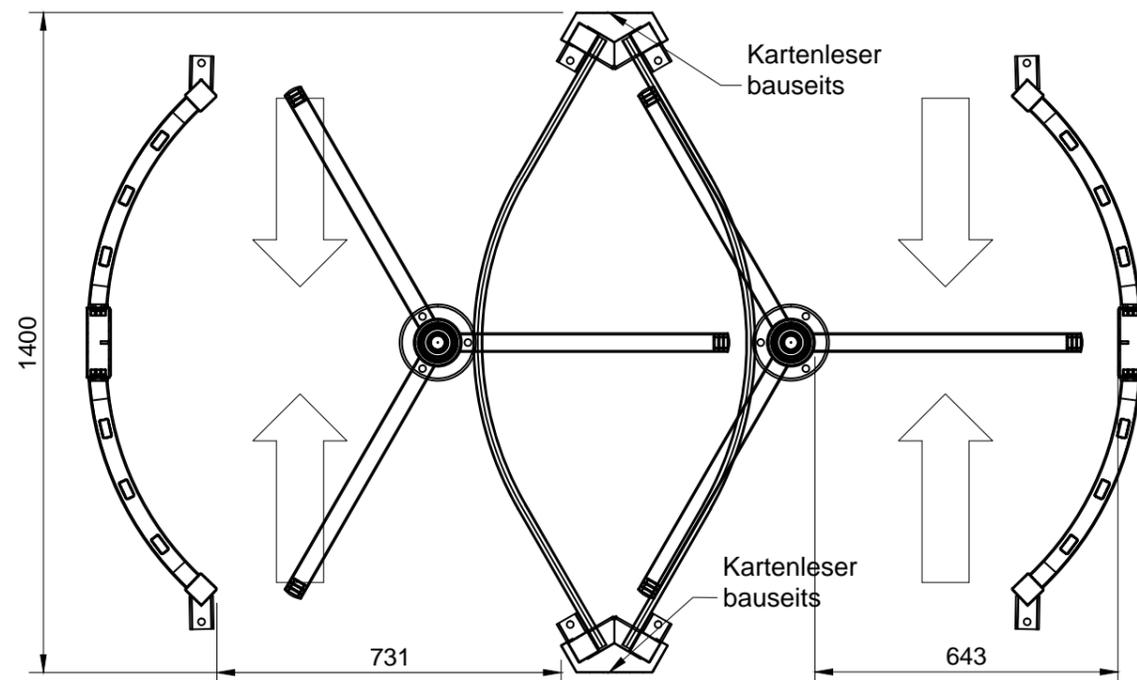
Hinweis: Das Drehkreuz TR-121 D ist im stromlosen Zustand nach außen dauerfrei und nach innen gesperrt!
